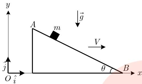
۱) جسم کوچکی به جرم  $m$  از نقطه‌ی  $A$  بالای سطح شیبداری با زاویه‌ی شیب  $\theta$  به پایین سر می‌خورد. ضریب اصطکاک جنبشی این جسم با سطح شیبدار  $\mu$  است. این سطح شیبدار مطابق شکل روی سطح افقی، همواره با سرعت ثابت  $V$  به سمت راست حرکت می‌کند.
